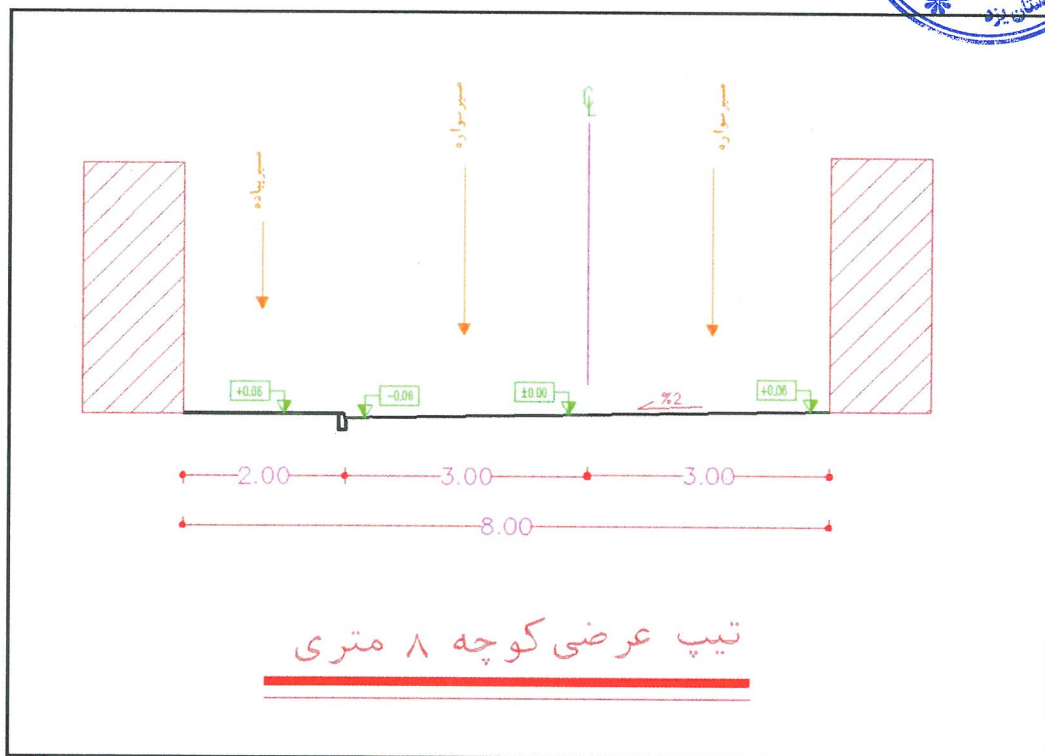
تصویر شماره ۴: مقطع عرضی (تیپ) خیابان ۸ متری
